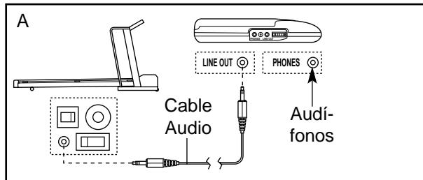
B. Enchufe un extremo del cable audio en el enchufe en frente de la caminadora cerca del cable eléctrico. Enchufe el otro extremo del cable en un adaptador-Y de 3.5mm (disponible en tiendas de aparatos electrónicos). Enchufe el adaptador-Y en el enchufe de PHONES en su disco compacto. Enchufe sus audífonos en el otro lado del adaptador-Y.
