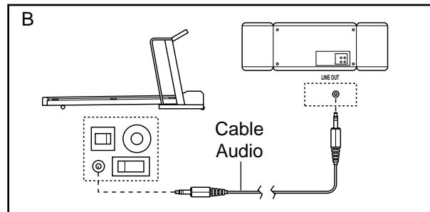
C. Enchufe un extremo del cable audio en el enchufe en frente de la caminadora cerca del cable eléctrico. Enchufe el otro extremo del cable en un adaptador-Y de 3.5mm (disponible en tiendas de aparatos electrónicos). Enchufe el adaptador-Y en el enchufe de PHONES en su estéreo. Enchufe sus audífonos en el otro lado del adaptador-Y.
