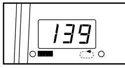
**IMPORTANTE: Asegúrese de que no hay una "d" en la pantalla de CALS/CALS GRASA.** Si una "d" aparece en la pantalla, la consola está en la función "demo". Esta función está hecha solo para usar mientras que la caminadora esté en exhibición en la tienda. Cuando la consola esté en la función demo, el cable eléctrico se puede enchufar, la llave se puede quitar de la consola,
