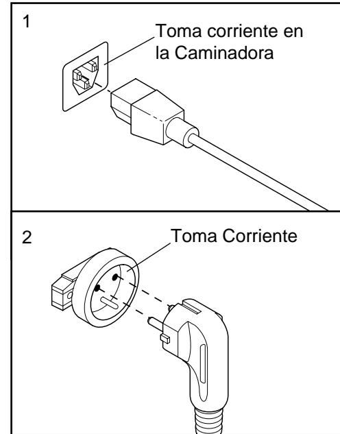
**! PELIGRO:** El no conectar el enchufe a tierra adecuadamente puede ocasionar una descarga eléctrica. Verifique con un electricista cualificado o con el personal de servicio cualquier duda que tenga con respecto a la conexión a tierra. No modifique el enchufe original. Si ésta no se adapta al toma corriente, el toma corriente es el que deberá ser cambiado por un electricista cualificado.
