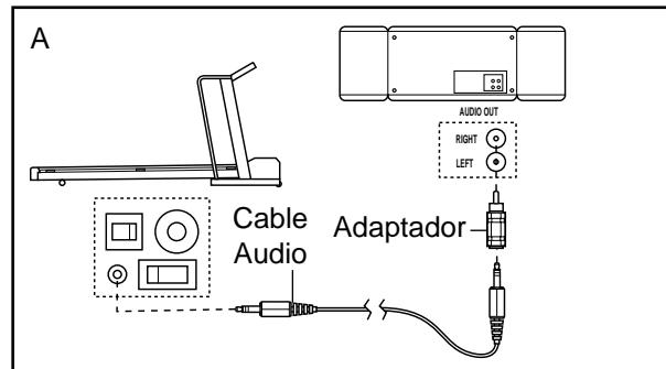
B. Enchufe un extremo del cable audio en el enchufe en frente de la caminadora cerca del cable eléctrico. Enchufe el otro extremo del cable en el enchufe de LINE OUT en su estéreo.
