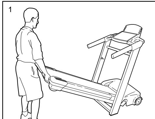
2. Coloque su mano derecha en la posición que se muestra a la derecha y sostenga la caminadora firmemente. Usando su mano izquierda, deslice la perilla del seguro a la izquierda y sosténgala. Levante la caminadora hasta que el pasador esté alineado con el orificio en el sostén. Lentamente suelte la perilla del seguro de tal manera que el pasador se deslice dentro del sostén.
