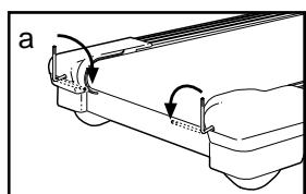
b. **Si la banda se ha movido a la derecha,** primero quite la llave y **DESCONECTE EL CABLE ELÉCTRICO.** Usando la llave "L", gire el tornillo de ajuste del rodillo izquierdo en el sentido opuesto de las agujas del reloj, y el tornillo derecho en el sentido de las agujas del reloj, 1/4 de vuelta cada uno. Tenga cuidado de no sobre apretar la banda para caminar. Conecte el cable eléctrico, inserte la llave y ande la caminadora por algunos minutos. Repítalo hasta que la banda esté centrada.
